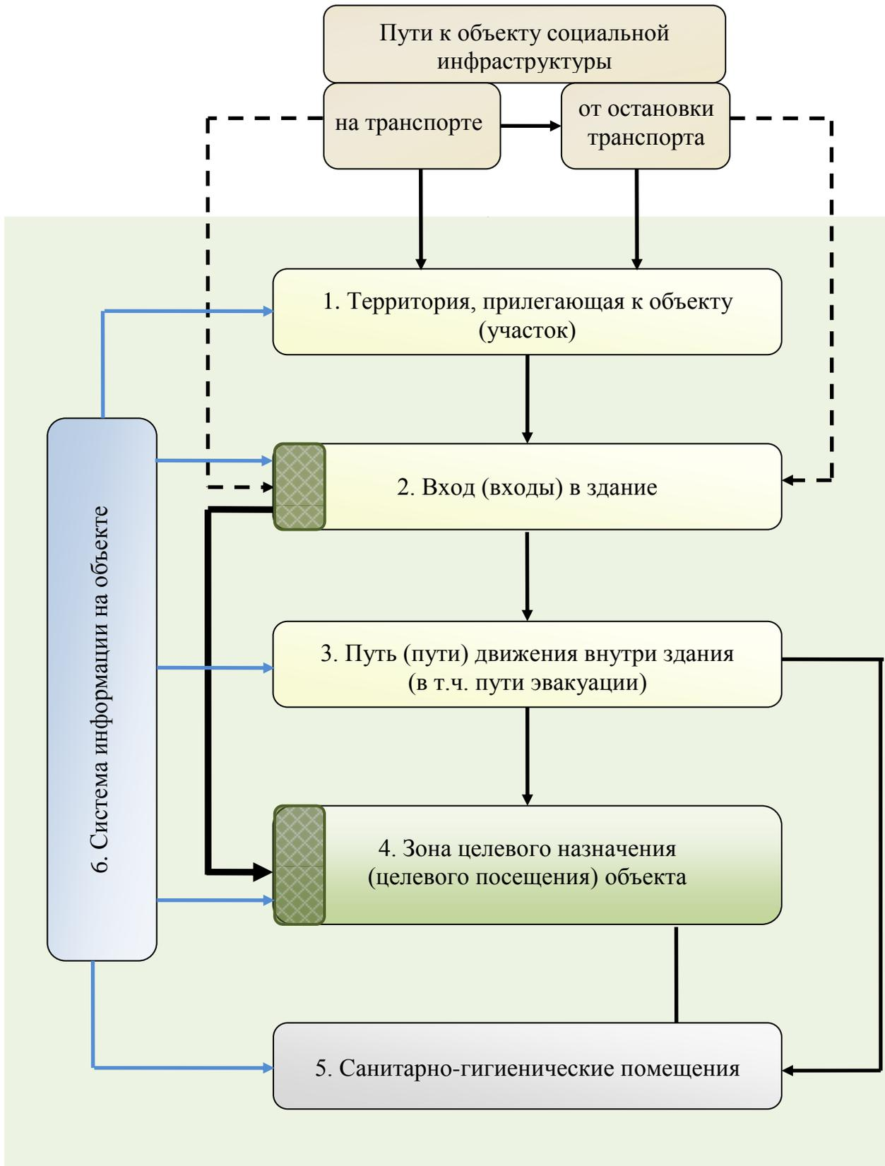
Рисунок 6. Схема взаимоотношения основных структурно-функциональных зон объекта социальной инфраструктуры.
